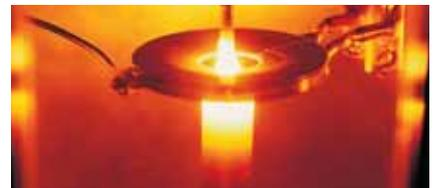
Technologie de connexion sur plaquette assistée par plasma à température ambiante
